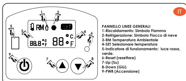
**QUESTA UNITÀ È DISEGNATA PER CONTROLLARE SISTEMI DI RAFFREDDAMENTO/RISCALDAMENTO SECONDO NECESSITÀ.**
